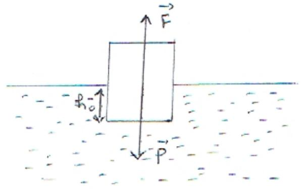
عندما يطفو الجسم الصلب (de corps flotte) هذا يعني أن هناك توازن بين ثقله و دافعة أرخميدس نسبي  $h_0$  : الارتفاع المغمور بالسائل.
